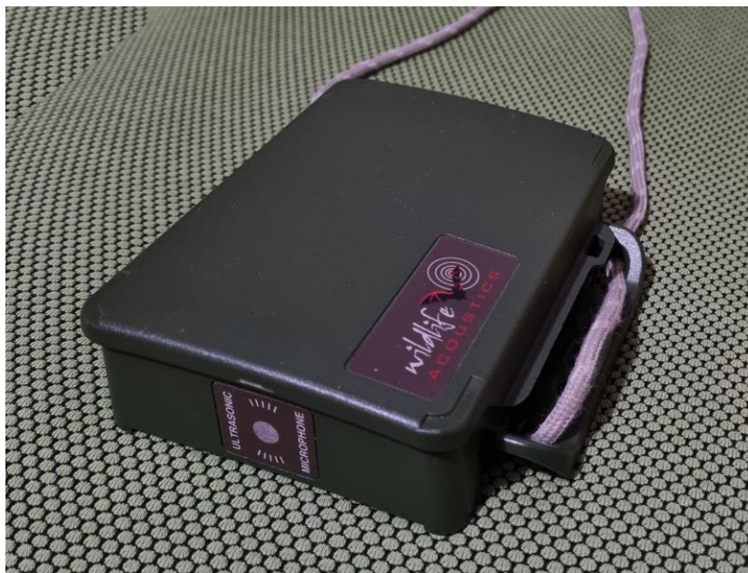
Figura 5-19: Bat detector Song Meter Mini Bat.
